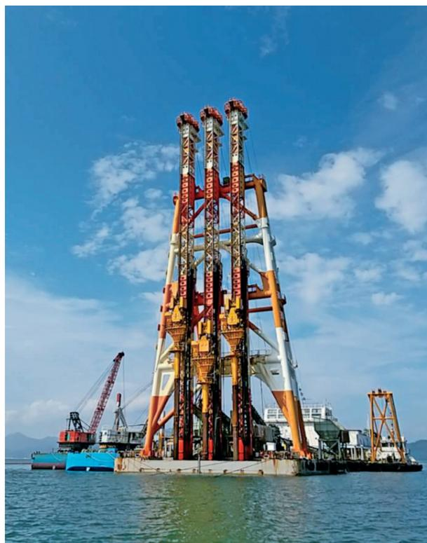
写真-2 海上SCP専用船「KSC-K75」
