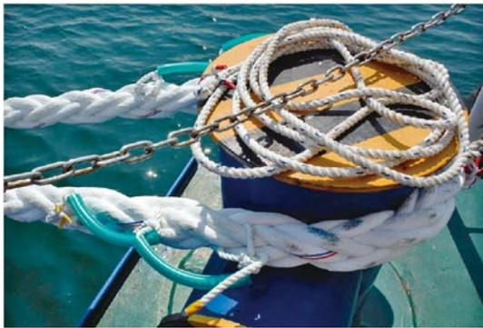
写真-6 「係留ロープの補助ロープ(耳)の活用」
