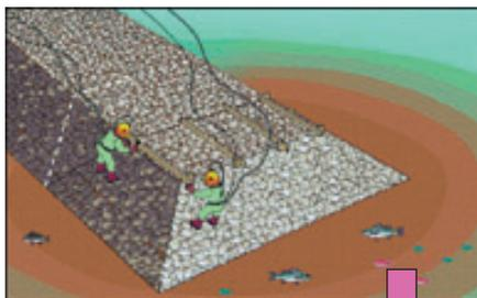
イラストでは潜水士が石を平らにならしていますが、最近では「捨て石ならし機」という機械を使っでの作業がふえてきています。
