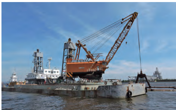
ハイブリッドシステムで油圧式に比べ燃料を約3割削減
