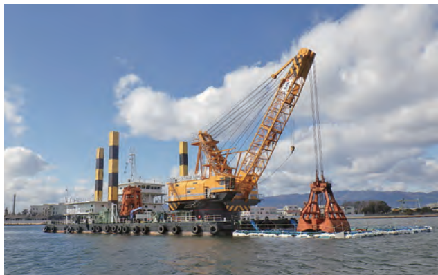
アンカーチェーンが床下に格納され、安全性も向上した青龍
