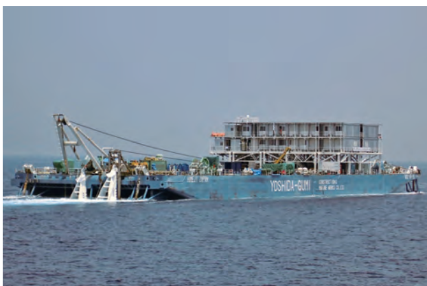
50室ある住居区や各種の計測機器などの特殊装置を取り付けた1万3,600トン積み台船『第二芳洋』
