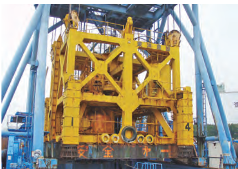
着座型タンバ式捨石均し機械。1日に200㎡以上の均しを実現
