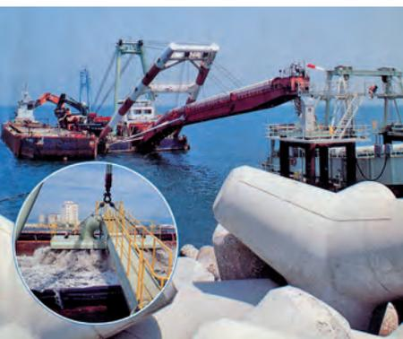
【上】クレーマ船で埋立土砂を陸揚げした。写真内は、アンローダー船による土運船への積込状況。
