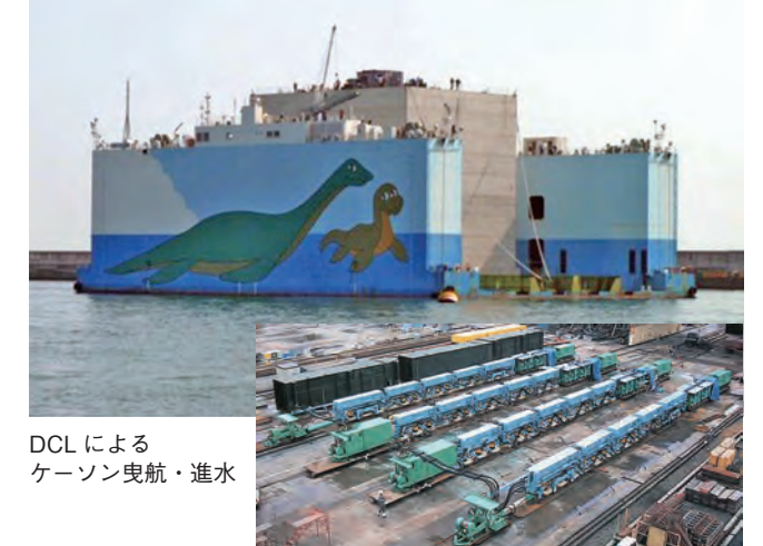
フルーズ(空気膜式ケーソン移動装置)
