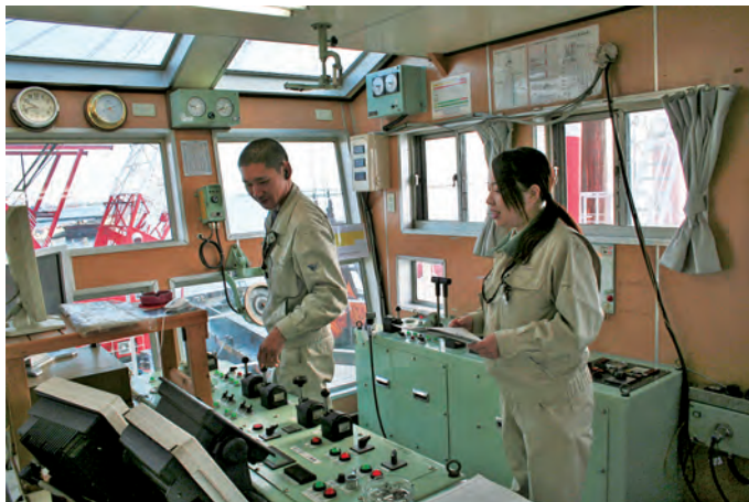
グラブ浚渫船「讃岐号」のブリッジに詰め、レーダーで作業区域内に入る一般船舶をチェックする。
