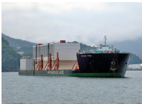
写真-5 HB ケーソンの海上運搬状況（撮影：平成 25 年 9 月）
