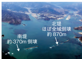
写真-4 湾口防波堤の被災状況 (撮影：左・平成23年4月、右・平成23年3月)
