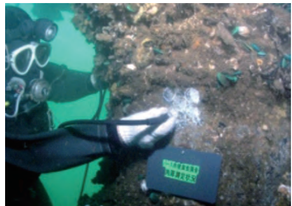
写真 超音波厚さ計による鋼の肉厚推定 国土交通省提供
