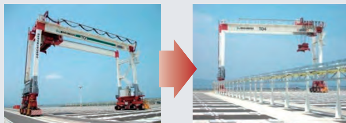
既存のトランスファークレーン 電動のトランスファークレーン
