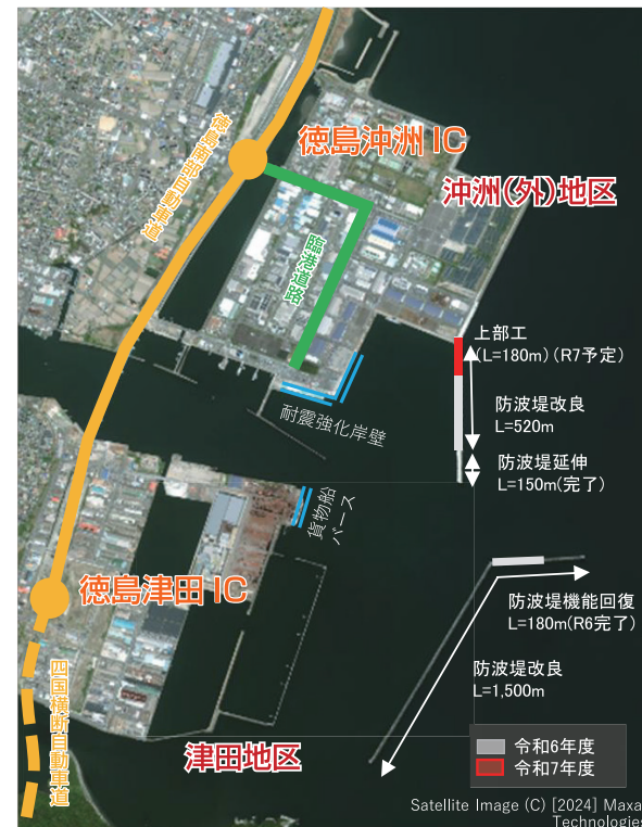
沖洲(外)地区、津田地区防波堤(改良)事業の概要
