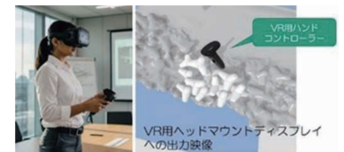
図-5 VR機器を用いたブロック据付
