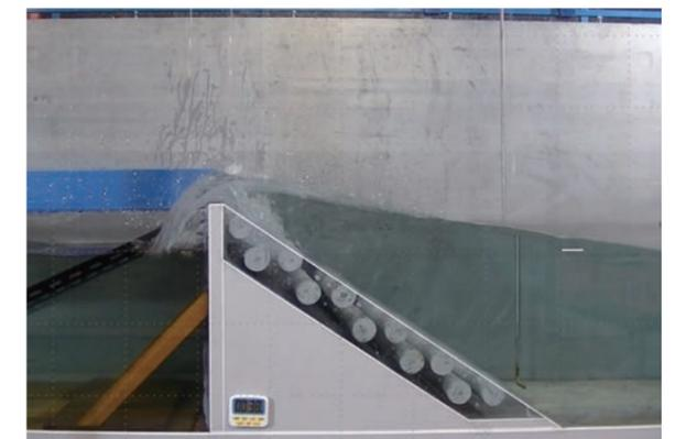
上段：消波工護岸(初期断面)の越波
