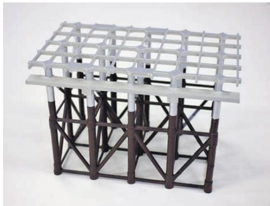
3Dプリンターで製作したジャケットの模型
