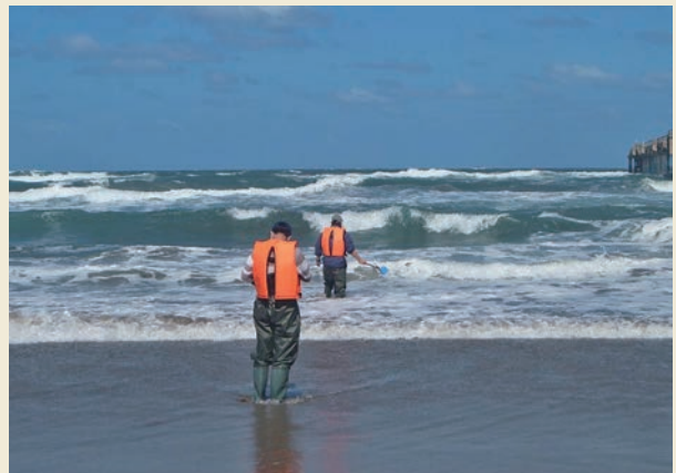
打ち寄せる波による底質移動調査のためのサンプル取得
