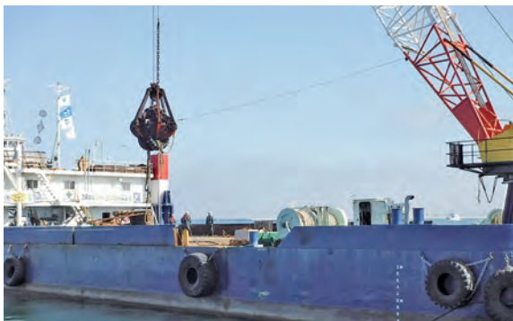
写真-8 地震津波総合防災訓練での航路啓開訓練(塩釜港区)
