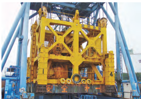
着座型タンパ式捨石均し機械。1日に200㎡以上の均しを実現
