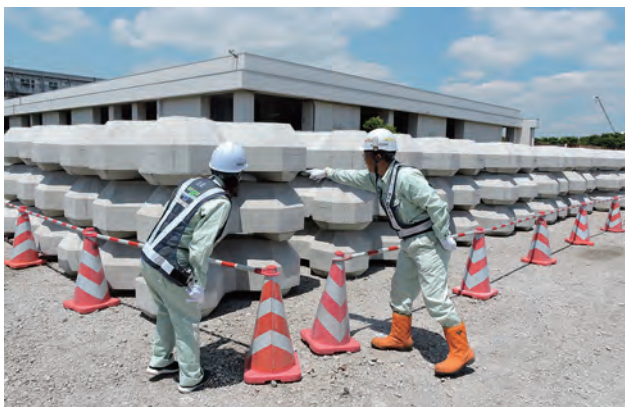
次々と製作され積み出しを待つエックスブロック
