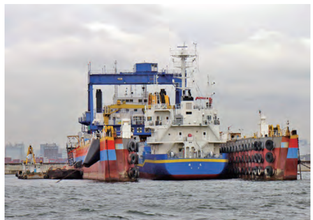
東京港で活躍中の作業船(汚濁防止枠付き土砂送泥船)
