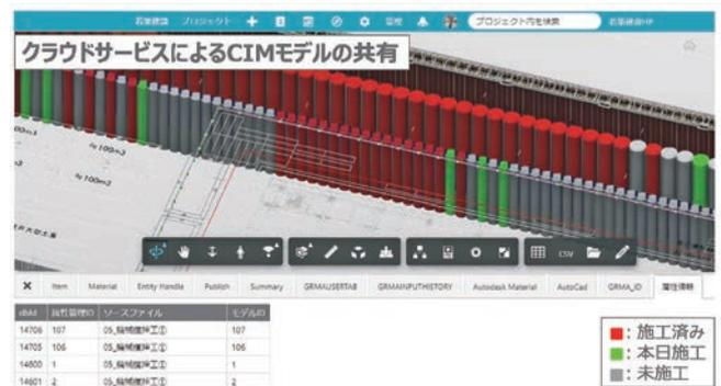
図-2 クラウドによる CIM モデルの共有 (港湾工事)
