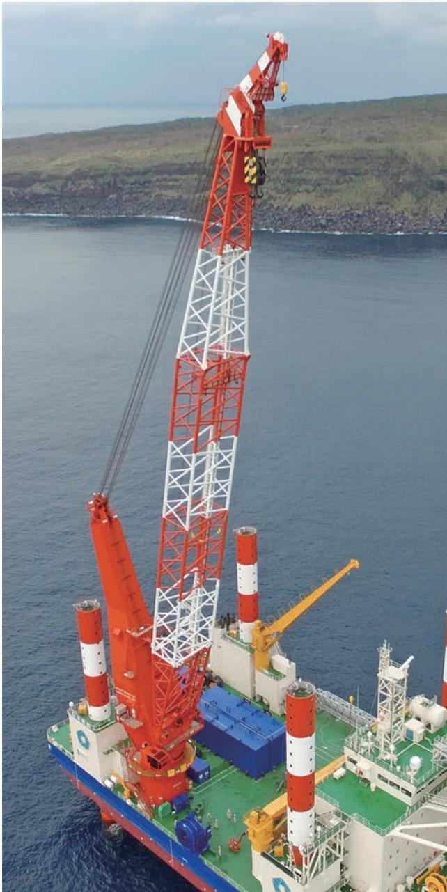
写真-2 800t 吊全旋回クレーン
