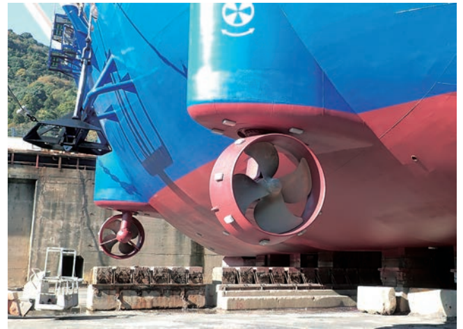
写真-3 船首部スラスター
