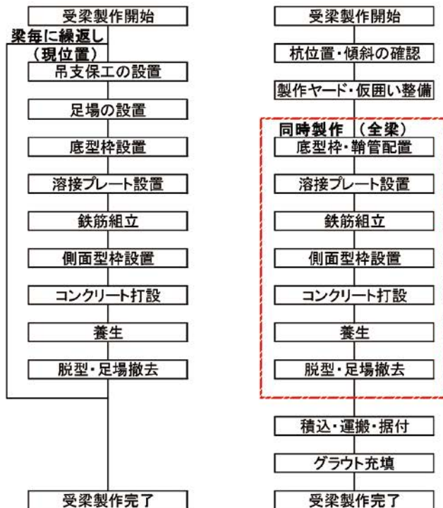
図-5 施工計画の変更(左:当初・右:プレキャスト)
