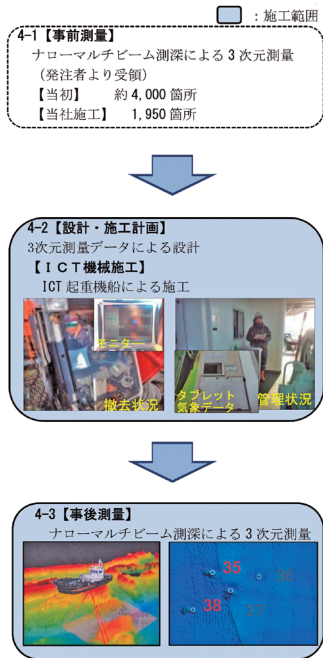
図-4 ブロック撤去の施工フロー
