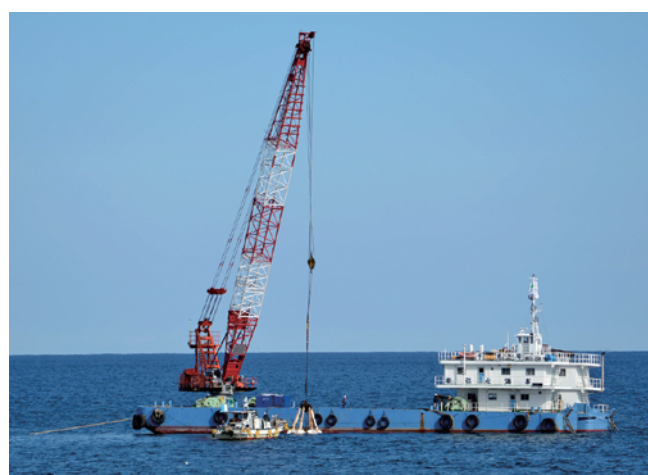
写真-2 起重機船「千恵号; 120t 吊」
