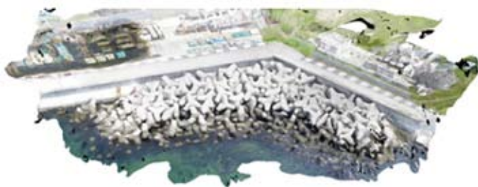
写真測量による消波ブロックの3Dオブジェクト
