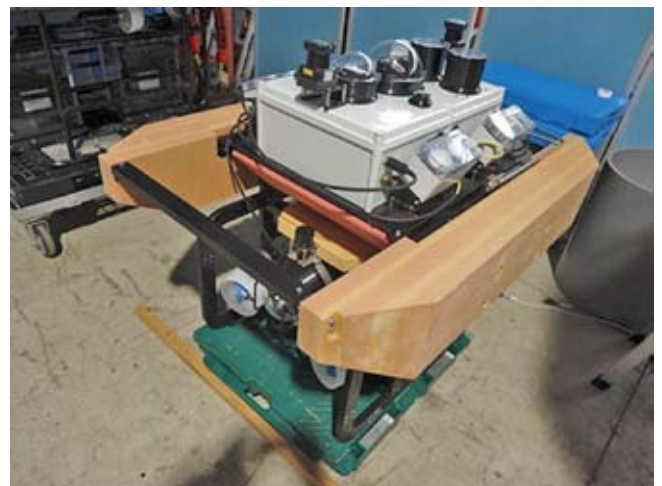
栈橋上部工下面点検用ROV(質量約80kg)
