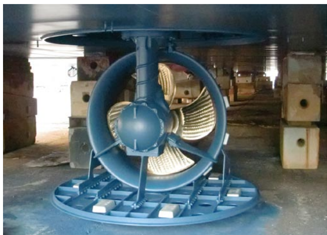
写真-3 昇降格納型のアジマススラスタ
