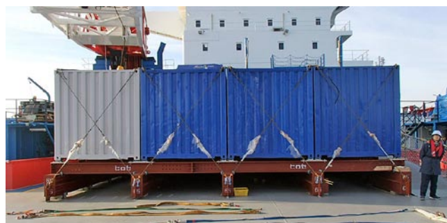
写真-13 AUV用コンテナ艀装
