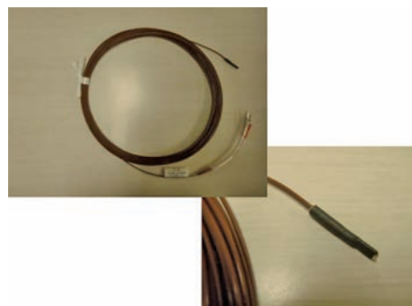
写真-2 コンクリート内部の温度測定用熱電対
