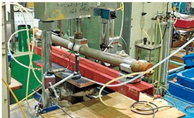
写真-1 曲げ試験状況
