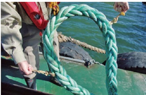
係留ロープの補助ロープ(結び目方式)
