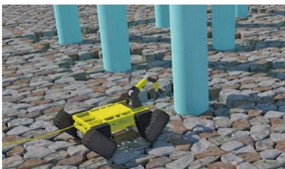
図-5 橋脚下部 洗掘調査 イメージ図
