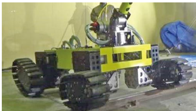
写真-2 段差乗り越え試験
