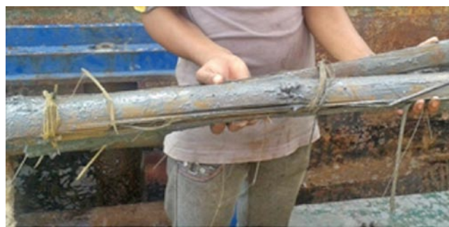
写真-1 撤去した竹杭
