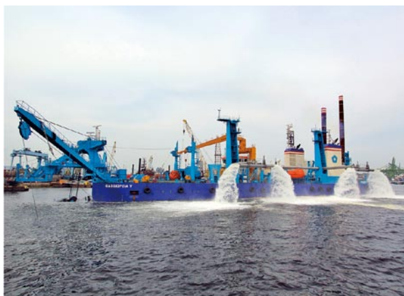
写真-9 バージローディング試運転状況
