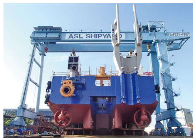
写真-2 推進器取付状況
