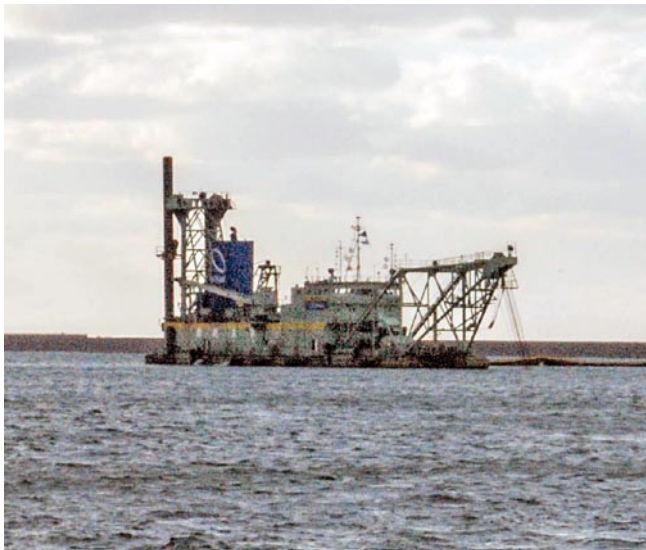
写真-4 ポンプ浚渫船 第五越後 (6000PS)
