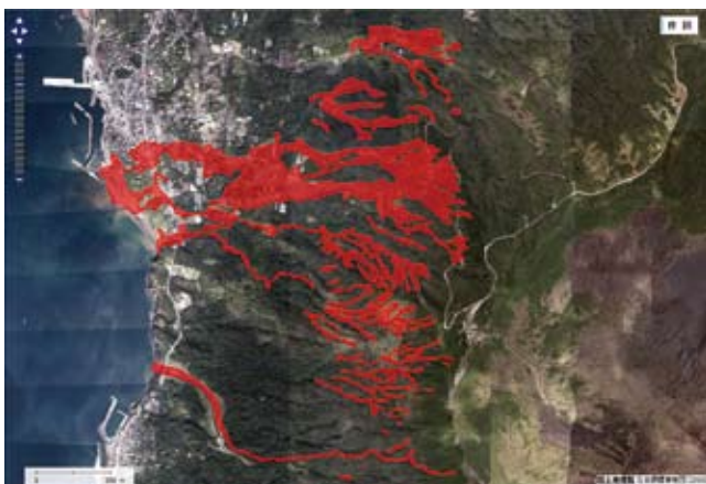
※赤いハッチ部が土砂流出箇所を示す
