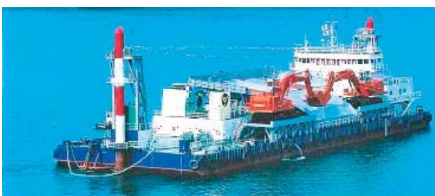
写真-5 空気圧送船(海援:6,430kw)
