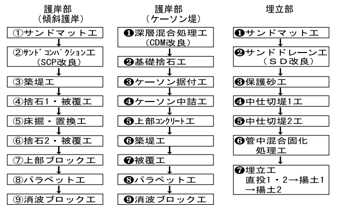
図-6 護岸部・埋立部の施工手順
