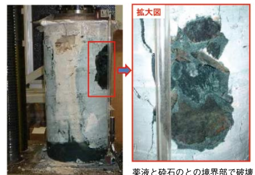
図-7 大型一軸圧縮試験破壊状況 (懸濁型薬液)
