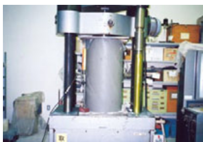
一軸圧縮試験状況(大型サンプリング試料)
